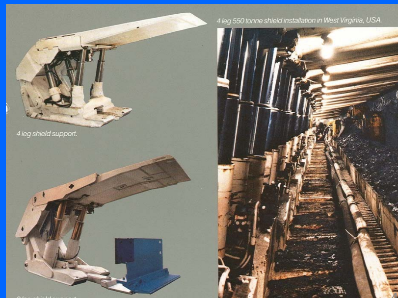
Osiguranje otkopa kompleksnom hidrauličnom podgradom
